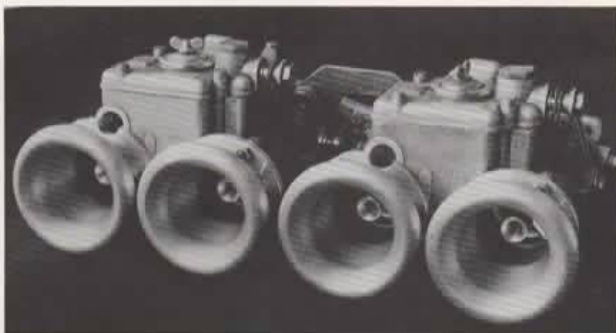
Ces deux superbes Weber 45 DCOE sont dotés de cornets d'admission courts et de centreurs de jets longs, ces éléments spéciaux étant entièrement usinés « maison » (préparation Sodemo pour moteur AX version « coupe »).
