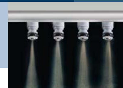
Korrekt funktionierende Einspritzventile
