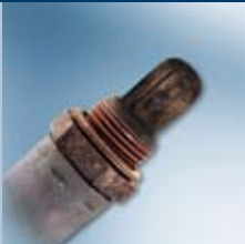
Gealterte Lambdasonde Neue Lambdasonde
