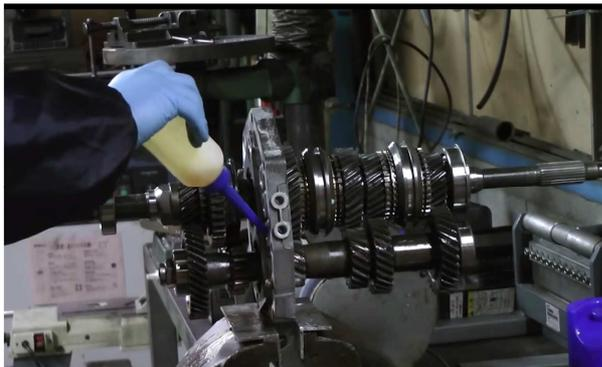
102. On lubrifie le passage des 3 tiges de fourchette sur la platine d'adaptation.
