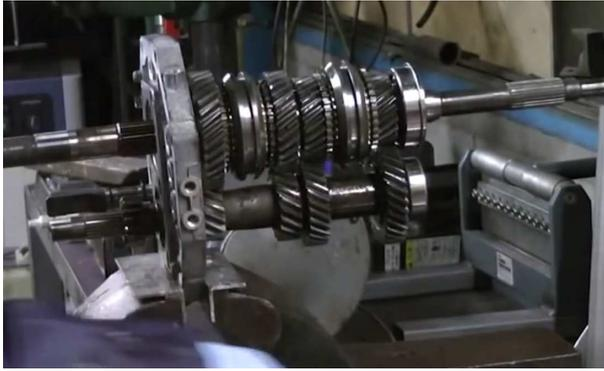
59. ....pour mettre en place l'insert de maintien (chapeau) du boîtier de synchro de 5ème....
