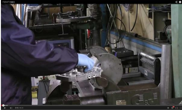
**1. Posez le roulement central de l'arbre secondaire ( de sortie) 6306 30mmx72mm dans son logement sur la platine d'adaptation**
