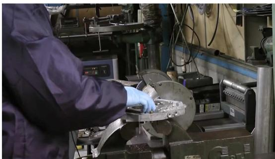
**5. Posez la plaque mainteneur de roulement sur la platine d'adaptation**
