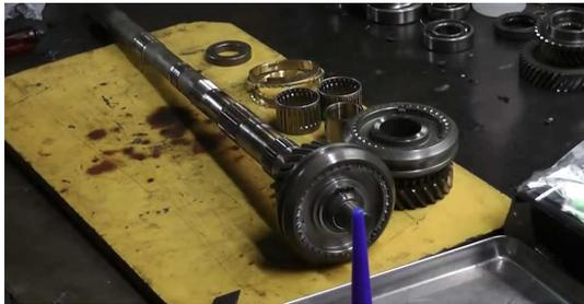
22. Préparer le pignon de 2<sup>nde</sup>, le moyeu de synchro de 1<sup>ère</sup>/2<sup>nde</sup>, les deux cages à aiguille...
