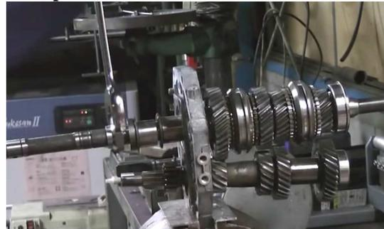
54. ....on visse (provisoirement) le gros écrou de l'arbre secondaire (sortie)...
