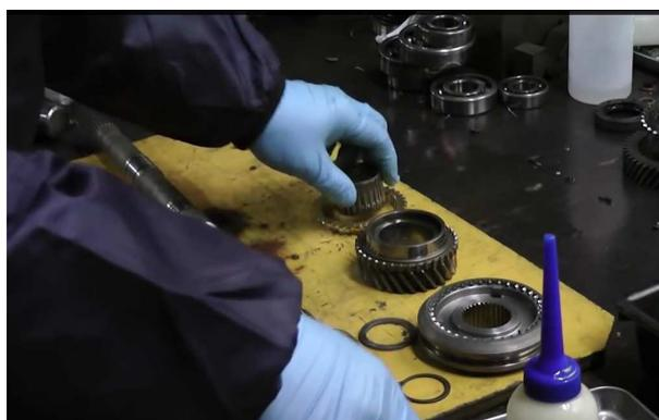
12. Mettez en place la cage à aiguille sur l'arbre secondaire,
