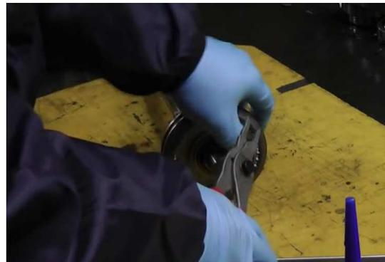
19. ....et prendre le circlip avec la pince à circlip.....
