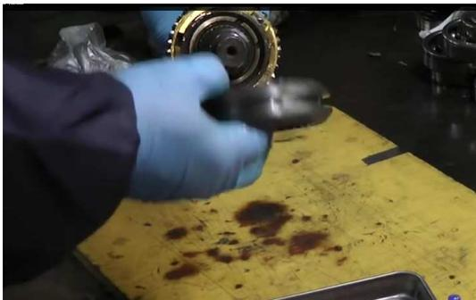
18. .... puis mettre en place le baladeur derrière le synchro puis la rondelle ....
