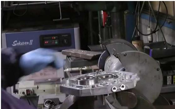
**3. Posez le roulement central de l'arbre intermédiaire 6305 C3 (25mmx62mm) dans son logement sur la platine d'adaptation**
