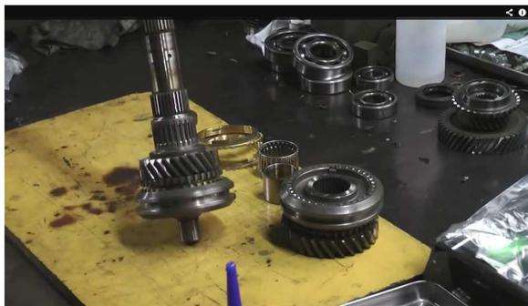
24. Placez la cage à aiguille derrière le pignon de 3<sup>ème</sup> .....
