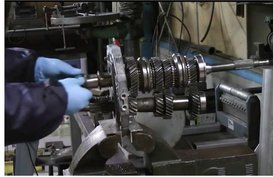
52. Il va falloir maintenant tirer les deux arbres (secondaire et intermédiaire) en parallèle dans leurs roulements centraux de la platine d'adaptation.
