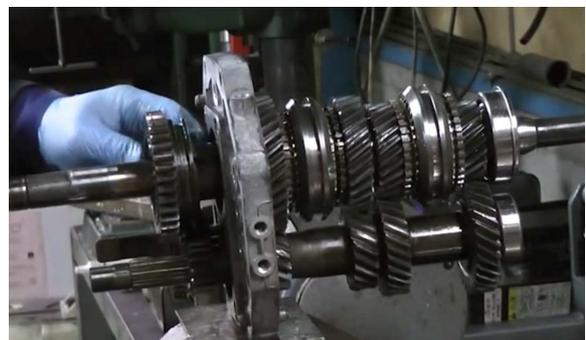
74. ....avec à l'intérieur le moyeu de 5<sup>ème</sup> contre l'insert de rétention....
