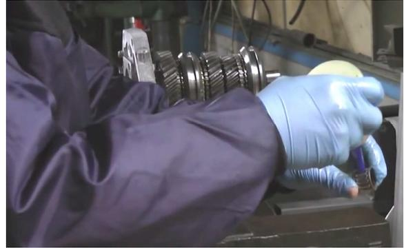
44. Il faut bien huiler la cage à aiguille (palier pilote) de l'arbre primaire (arbre d'entrée).....
