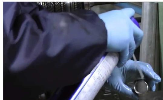
89. On lubrifie l'écrou de blocage de l'arbre secondaire....
