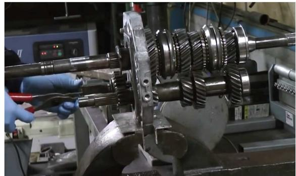
72. ....et on termine en posant le circlip dans sa rainure.
