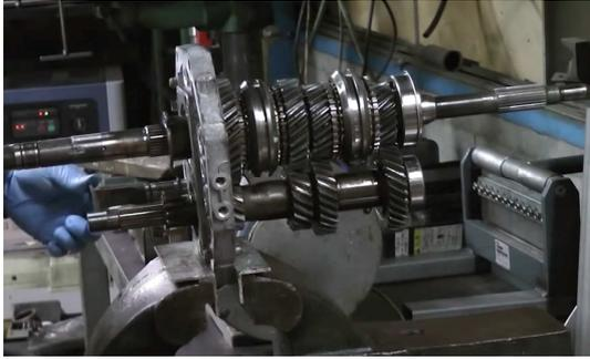
67. Sur l'arbre de renvoi de marche arrière on place d'abord le circlip et la rondelle de poussée....
