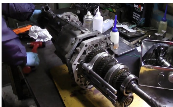
18. ....on enlève l'ensemble extension arrière...avec ....
