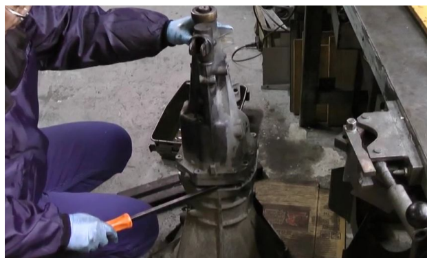
15. ...pour désolidariser la cloche de la platine d'adaptation....
