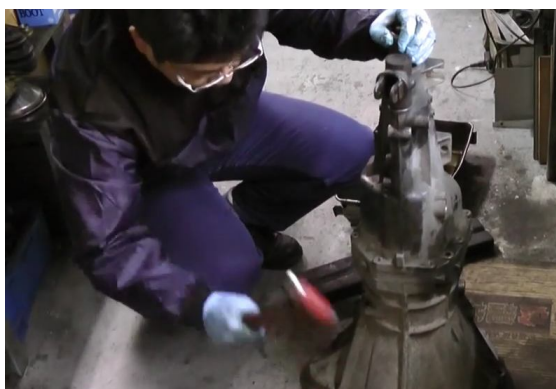
14. ....puis tirez la en tapotant légèrement avec un marteau mousse...
