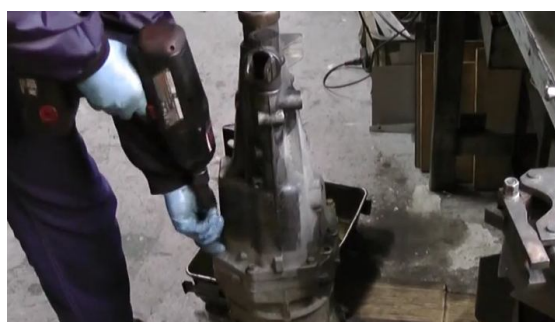
13. Enlevez les boulons de fixation de l'extension arrière.....
