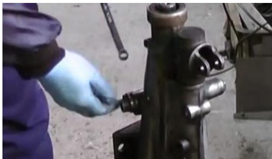
1. Enlevez la goupille de maintien du guide du pignon du tachymètre.
