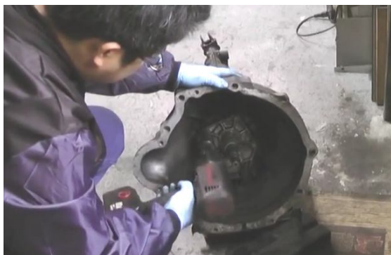
8. Enlevez les boulons de fixation...
