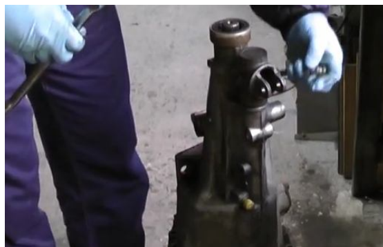
3. ...puis le ressort de rappel de la commande de la marche arrière et son piston.
