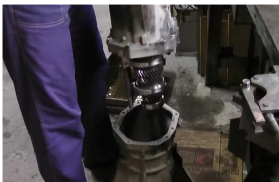
16. ...et l'enlever du boîtier de transmission.
