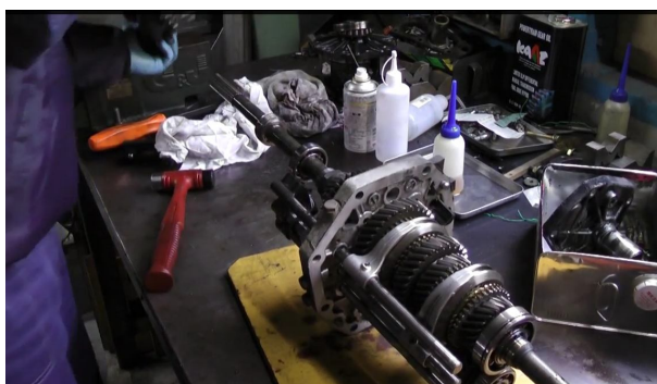
18. ....on enlève l'ensemble extension arrière...avec ....
