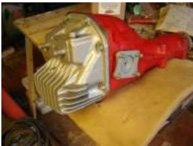
Démontage du bouchon de remplissage du différentiel. J'ai bataillé pour le démonter car le carré était foiré, j'ai dû ressouder des écrous pour qu'enfin il puisse venir. Démontage de l'entrée du différentiel pour changer le joint spi. (L'écrou est serré à 20,5 m·kg.) Ouverture du différentiel pour vérifier qu'il n'y a pas de limaille.
