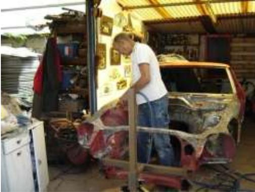
Maintenant décapage de la caisse avant l'apprêt avec des brosses métalliques rotatives
