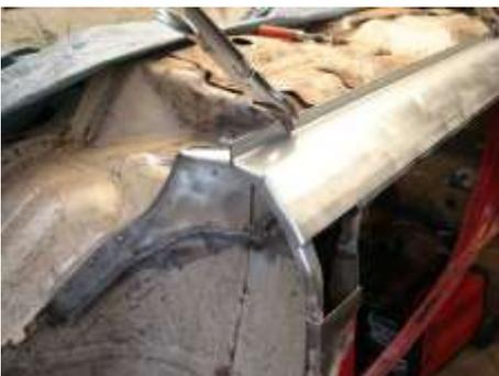
Maquettage en carton et fabrication d'un morceau de passage de roue derrière le bas de caisse
